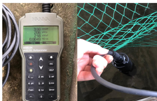
Hình 2.4. Đo oxy hòa tan trong nước bể nuôi
